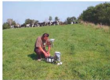
با GSM-19 همگام سازی مغناطیس سنج ایستگاه پایه، سنسور و کنسول مغناطیس سنج مرجع برای محافظت در برابر تغییرات دما در یک روکش فویلی ویژه قرار گرفته‌اند.
